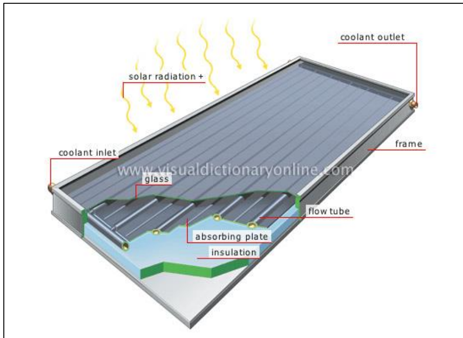
Εικόνα 1.17: Τμήματα ενός επίπεδου ηλιακού συλλέκτη
